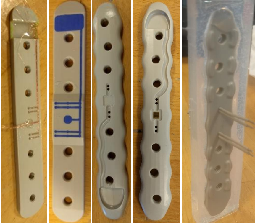
Abb. 62 Von links nach rechts sind die aufsteigenden Entwicklungsstufen (1-4) der Osteosyntheseplatte dargestellt. Links ist die erste Version einer Osteosyntheseplatte mit minimalen Änderungen einer einfachen Quaderform mit abgerundeten Kanten mit isolierten Kupferlackdraht dargestellt, welche bereits zur Testung vergossen wurde. Es wurden hier bereits erste Erkenntnisse für die Verkapselung und Hürden (Erhöhung der Viskosität beim Aushärtungsprozess, Ablaufen durch die Elektrodenlöcher) gewonnen. Rechts davon ist eine Version mit Verstärkung der durch die Aussparung für Elektroden geschaffenen Schwächung der mechanischen Struktur. Hierbei sind verschiedene mögliche Positionen für die Elektroden vorgesehen. Problematisch hat sich hier beim Verkapseln die Schräge dargestellt sowie Kapillarkräfte zwischen Silikonnegativ (abgenommen von der realen Platte durch Verfüllen mit blauer Knetmasse) und der Platte. Rechts davon ist die Vorversion zu den abschließend genutzten Prototypen gezeigt, welche einen kürzeren Abstand zwischen Elektroden und Schraublöchern aufweist. Der abschließende Prototyp (Version 4) ist vorder- und rückseitig in den rechten Bildern veranschaulicht.
