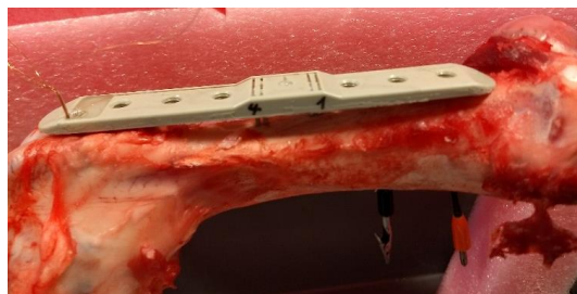
Abb. 57 Entwicklungsschritt zum Prototyp angebracht am Femur eines Schweines zum Messen der Veränderung der Impedanz über einen längeren Zeitraum (Langzeitmessungen)
