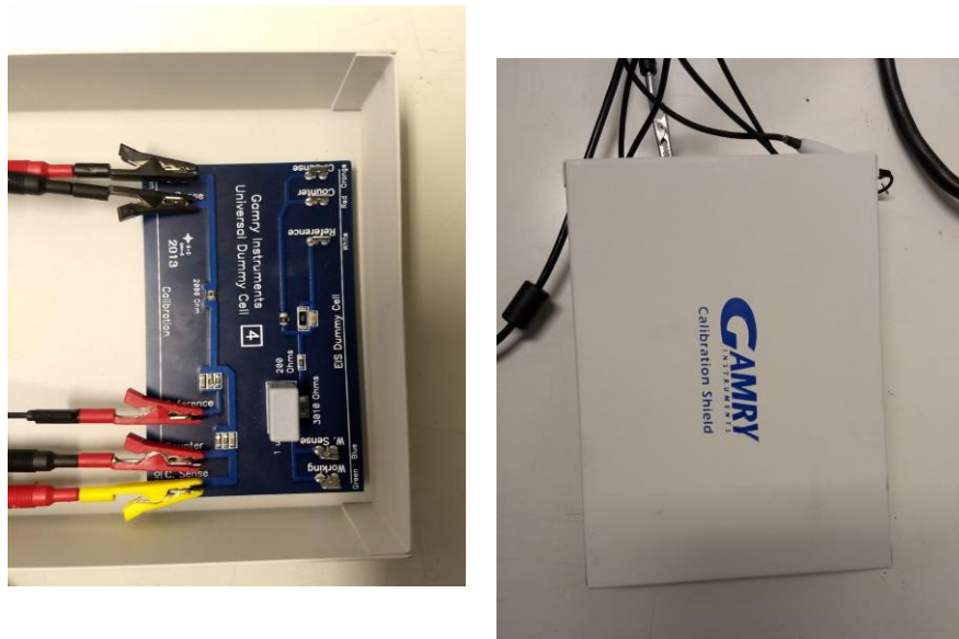
Abb. 55 Kalibrieren des Gamry Interface 1000E: Links: Anschluss an die Dummy Cell mit Hilfe von Krokodilklemmen; Rechts: Abgeschirmte Kalibrierungsmessung innerhalb eines Faraday'schen Käfigs.
