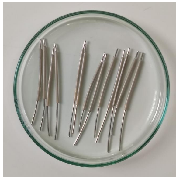
Abb. 44 Elektroden aus verzinneten Kupferkabel (unten) und Platinelektrode (oben) ummantelt von einer PEEK-Kapillare zum Verlöten mit der Elektronik der instrumentierten Osteosyntheseplatten
