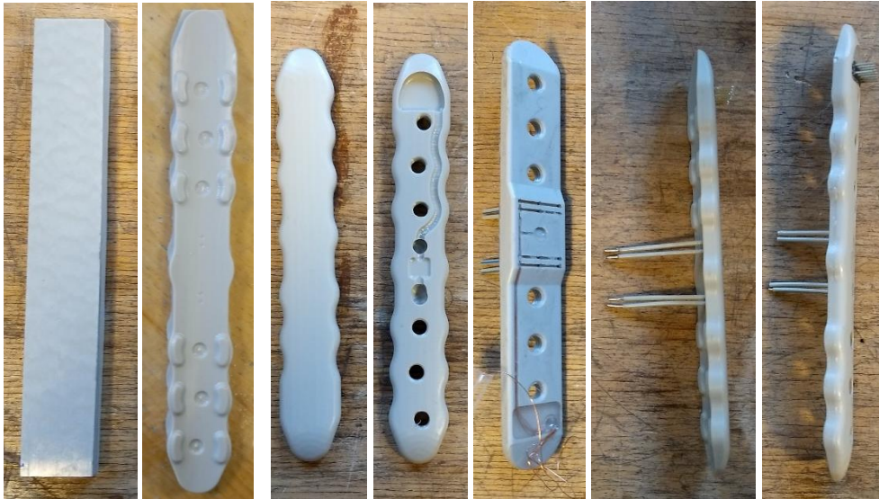
Abb. 39 Verschiedene Stadien der Herstellung, Bearbeitungsfehler und Vergleich verschiedener Versionen der Osteosyntheseplatte aus PEEK, von links nach rechts dargestellt sind: PEEK-Zuschnitt zur Herstellung der Osteosyntheseplatten, bearbeitete Unterseite, Form ohne Nuten oder Schraubenlöcher zum Herstellen eines Negatives, Form mit Nut (fehlerhafte Bohrung für Elektroden), frühere Version der Osteosyntheseplatte, ältere verkürzte Variante der Osteosyntheseplatte und die finale Osteosyntheseplatte.
