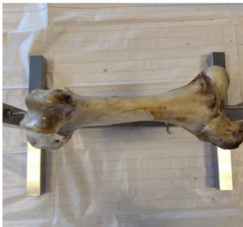
Abb. 53 Getrockneter Rinderknochen (Trocknung: ca. 120 °C über 10 Stunden, finales Gewicht: ca. 3 kg) – Links: Befestigt in der Halterung; Rechts: Versatz zwischen den Knochen durch Verspannungen beim Einbringen
