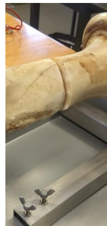
Abb. 53 Getrockneter Rinderknochen (Trocknung: ca. 120 °C über 10 Stunden, finales Gewicht: ca. 3 kg) – Links: Befestigt in der Halterung; Rechts: Versatz zwischen den Knochen durch Verspannungen beim Einbringen
