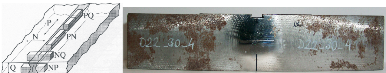
Abbildung 9 Probenentnahmeorte (links) und Probe zur Ermittlung der \delta_5 – Werte (rechts)
