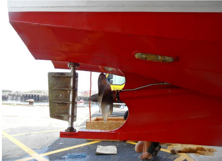
Abbildung 5.15.: Heck des Steuerbordrumpfes des Forschungskatamarans „Princess Royal“ der Universität Newcastle (Atlas u. a. 2013).
