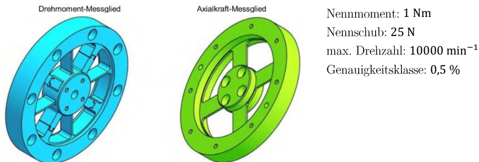
Abb. 6.20: Messglieder des Propellerdynamometers (links) und Kennwerte (rechts)
