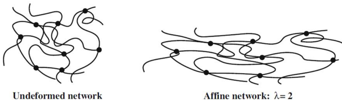
Abbildung 2.10: Verformung entsprechend der Affine-Netzwerktheorie, [51]
