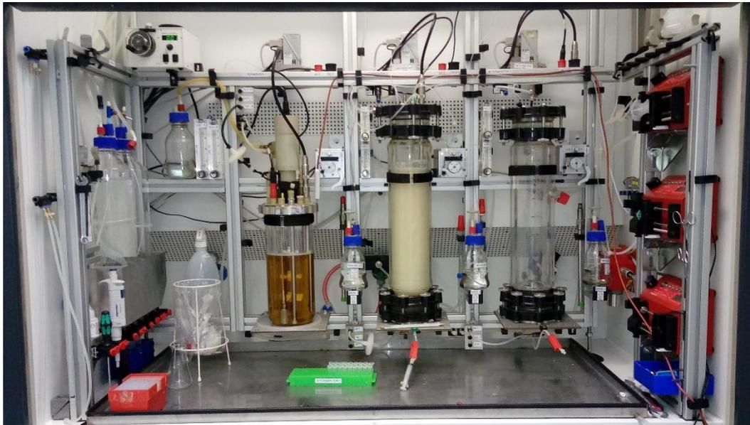
Abbildung 14 : Reaktoraufbau im Laborabzug; Rührkesselfermenter zur Hochzelldichtefermentation; Zwei 2 L Blasensäulen zur fermentativen Oxidation von Butan; Peripherie zur Kontrolle inkl. Sicherheitseinrichtungen; Kabel, Rohre und Schläuche rückseitig auf den Aluminiumprofilen geführt
