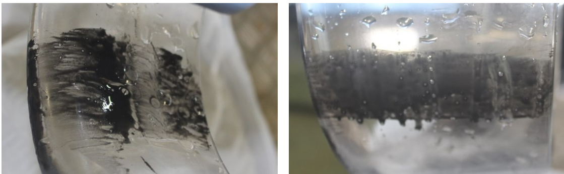
Abbildung 76: Farbanstrichversuch, D287 mit VP1871, P_{0,7}/D = 1,2 ; J = 0,0 ; n = 12 1/s
