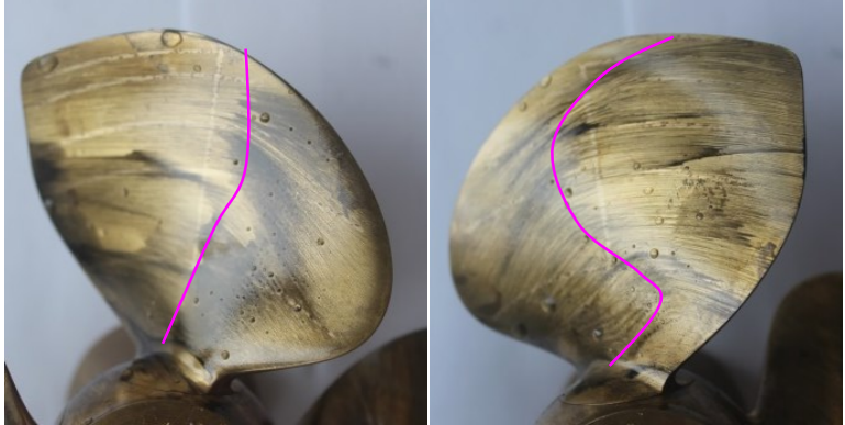
Abbildung 74: Stromlinien VP1871, P_{0,7}/D = 1,2 ; J = 0,0 ; n = 12 1/s
