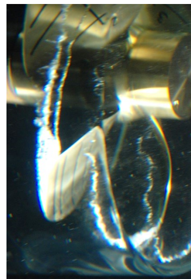
Abbildung 68: Beispielhafte Kavitationsfotos VP1871-D287, P_{0,7}/D = 1,20 ; s = 1,5 mm; J = 0,15 ; n = 28 1/s; Re \approx 1,2 \cdot 10^6
