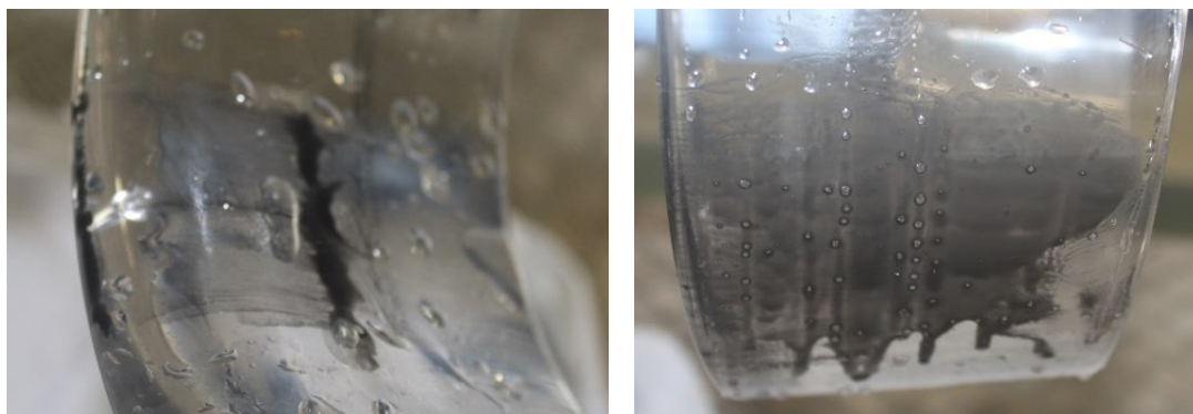
Abbildung 77: Farbanstrichversuch, D287 mit VP1871, P_{0,7}/D = 1,2 ; J = 0,0 ; n = 25 1/s
