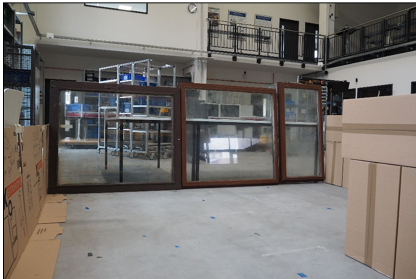
Abbildung 8: Integration einer Fensterfront für den Testfall Fenster
