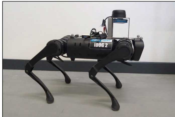
Abbildung 20: Aufbau vierbeiniger Laufroboter mit LiDAR-Sensor Slamtec RPLidar A3M1
