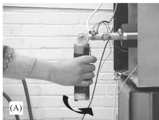
Bild 4: Untersuchung der dynamischen Eigenschaften des Anwenders in Rotationsrichtung [6]
