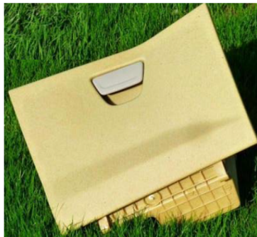
Bild 6: Spritzgegossenes Handschuhfach aus sisalfaserverstärktem Polypropylen (PP).
