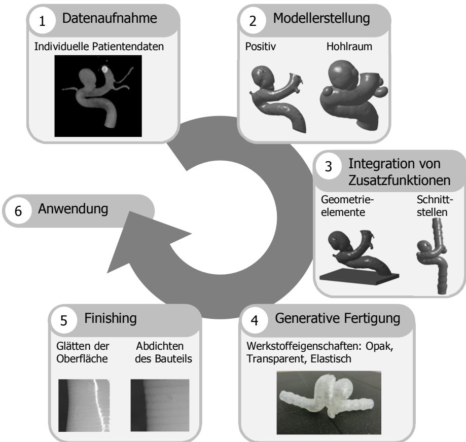
Bild 6: Übersicht des Produktentstehungsprozesses von Gefäßmodellen intrakranieller Aneurysmen
