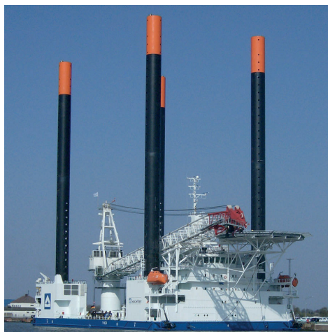
Abbildung 3.1.: Errichterschiff mit zylindrischen Jack-Up-Beinen [50].
