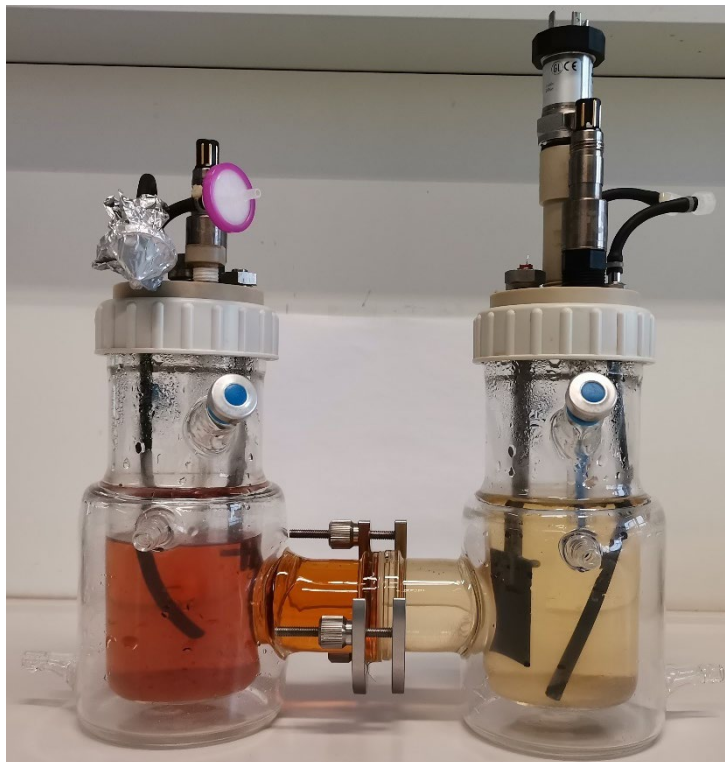
Abbildung 37 Eigenfärbung des Mediums im großen Reaktor (Reaktor 2) nach der Elektrofermentation bei -700\text{ mV} mit Mc. maripaludis nach dem II. Medienwechsel bei der Untersuchung der Stabilität der Elektromethanogenese, Kathode (links) Anode (rechts)
