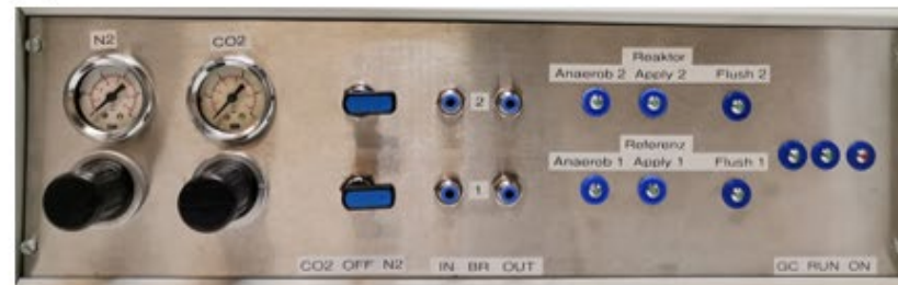
Abbildung 10 Rohrleitungs- und Instrumentenfließschema der großen H-Zelle. (A) Rohrleitungs- und Instrumentenflussdiagramm, (B) tatsächlicher Aufbau des Kontrollsystems, (C) Vorderseite des Kontrollsystems mit verschiedenen Anschlüssen für die Zufuhr und Abnahme von Gas
