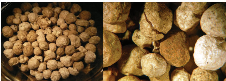
Abbildung 10.2. – Granulatprobe aus der Versuchsanlage auf MS „Timbus“ nach der Aufzeichnung der Durchbruchkurve
