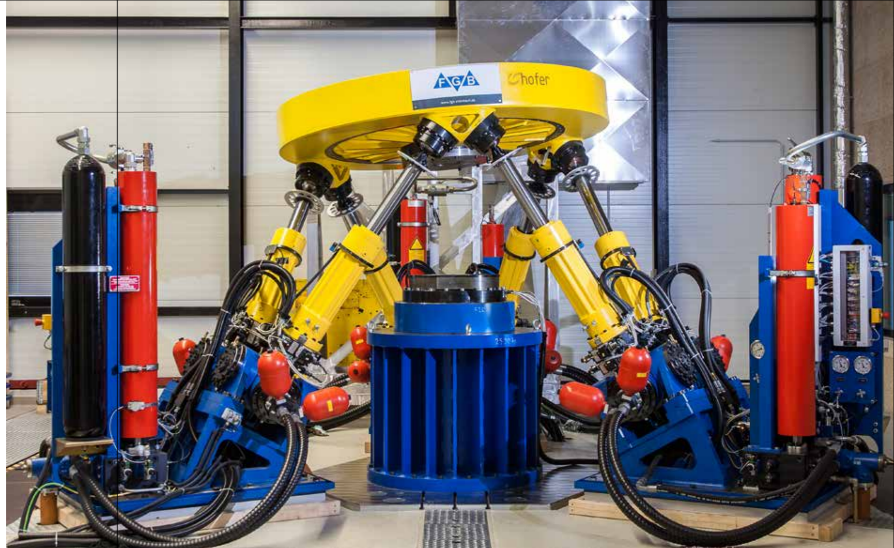
Der drei Meter hohe Hexapod ruht auf einem räumlich abgekoppelten Betonsockel
