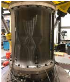
Bei großem Druck verbeult sich der Zylinder
