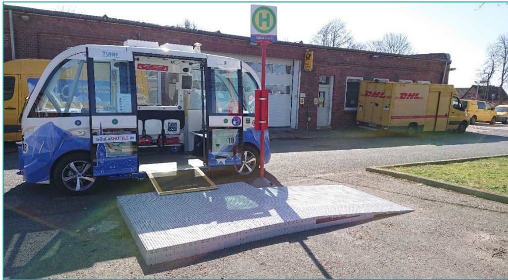
Abbildung 10-1: Entwickelter Haltestellenpodest am Postverteilzentrum in Lauenburg/Elbe aus Kunststoff (eigene Aufnahme)
