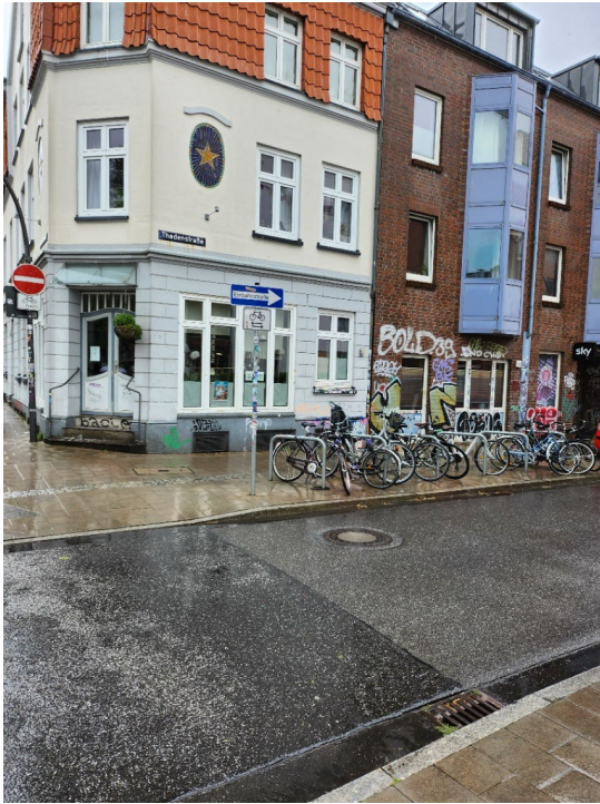
Abbildung 16: Einbahnstraße mit Freigabe für den Radverkehr entgegen der Fahrriichtung mit Zeichen 220 StVO und Zusatzzeichen 1000-32
