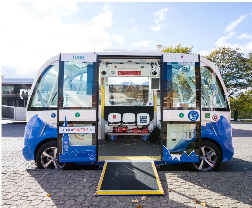
Abbildung 14: Das TaBuLaShuttle an der Haltestelle Lauenburg/ZOB mit ausgefahrener Rampe
