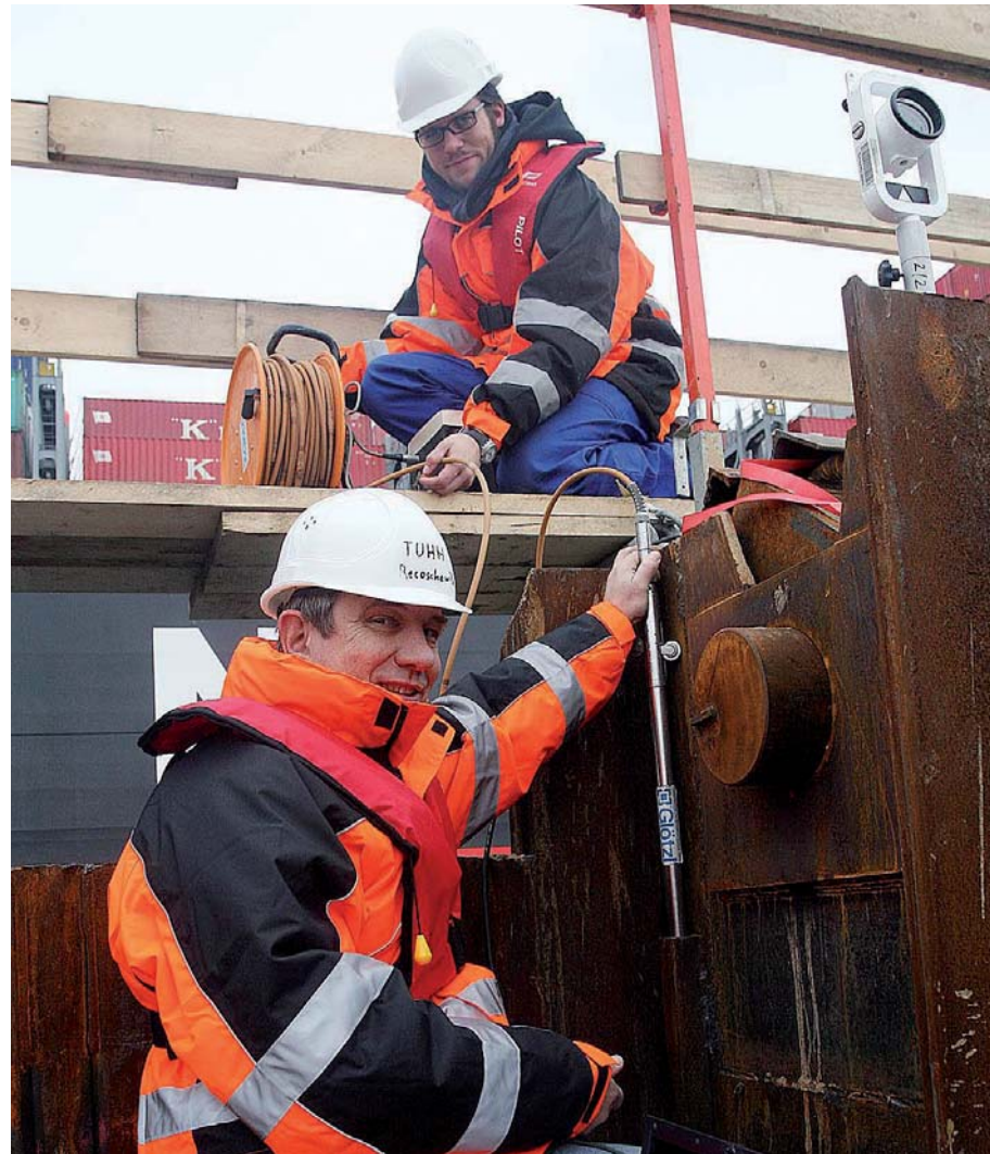
Steffen Kinzler (oben) und Techniker Jörg Recoschewitz messen mit einem Vertikalinklinometer die Verformung der Spundwand.
