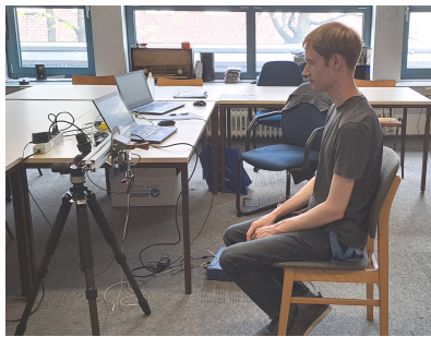
Abbildung 6.7: Links: Fotografie des Versuchsaufbaus zur Vitalparametermessung einer gerade vor dem Radar sitzenden Person. Rechts: Vom Radarsystem geschätzte Entfernung.
