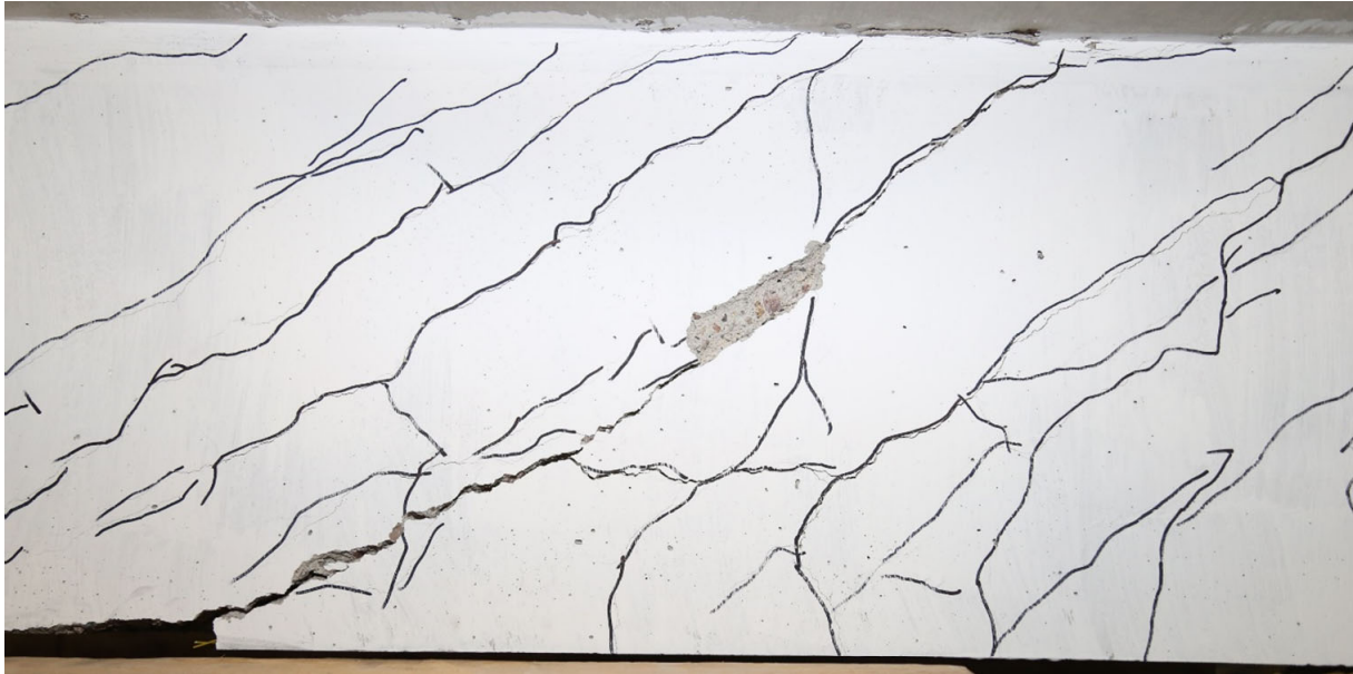
Bild 170 B6.1 Maßgebender Biegeschubriss nach Versuchsende (gespiegelt)
