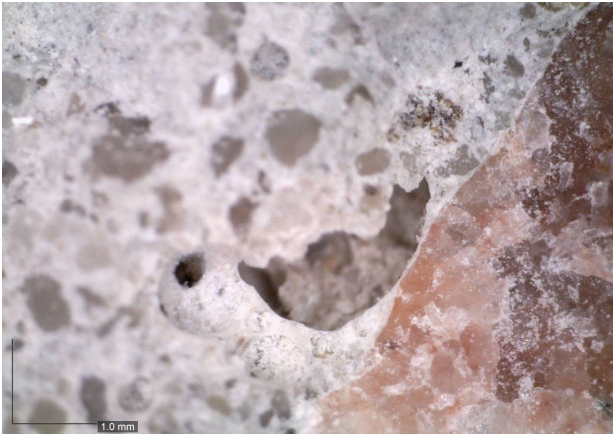
Bild 403 Bereich 1, Einbettung des roten Korn in die Zementmatrix
