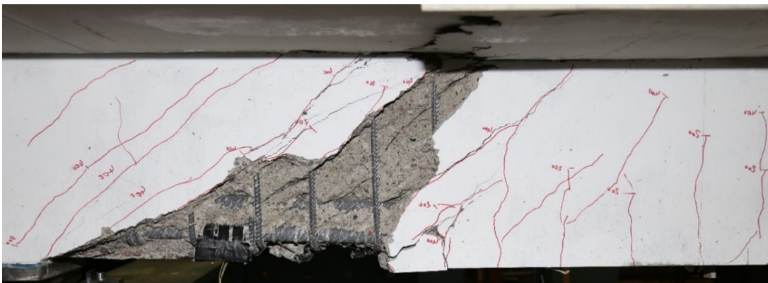
Bild 184 B6.2 Versagensbild nach Versuchsende (gespiegelt)
