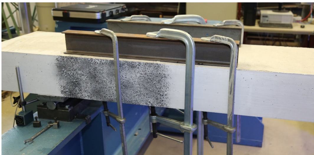
Bild 115 B3.2 Extern vorgespannte „Querkraftbewehrung“
