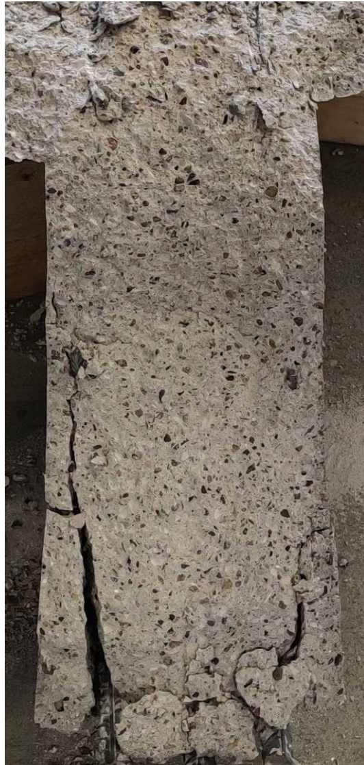
Bild 440 B7.2.2 untere Rissoberfläche
