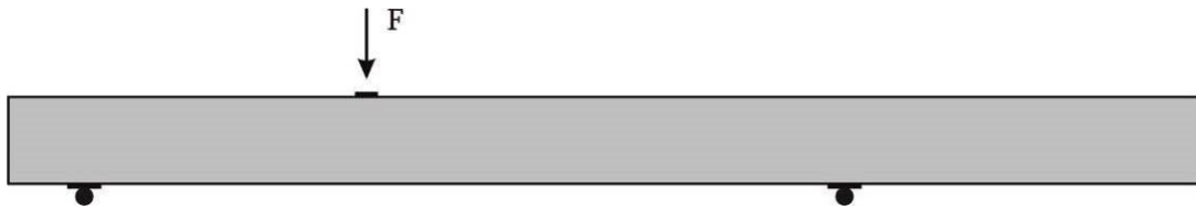
Bild 1 Balken für die Querkraftversuche
