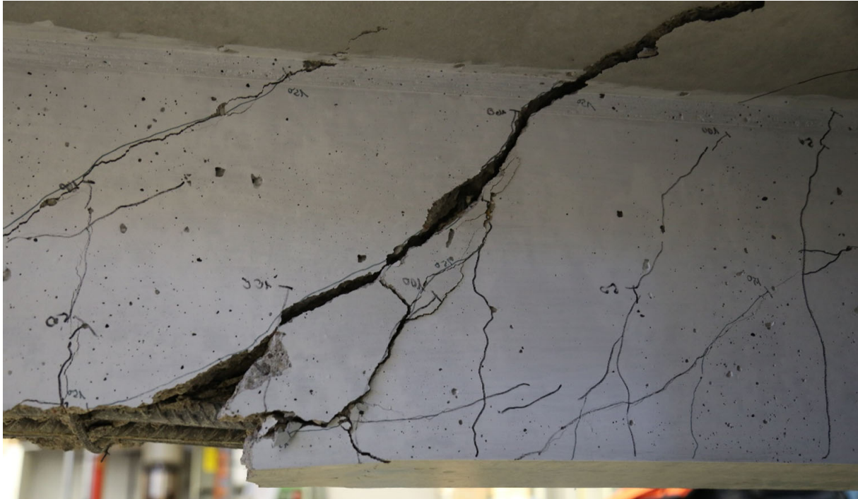
Bild 242 B8.1 Maßgebender Biegeschubriss und Bügelversagen nach Versuchsende (gespiegelt)
