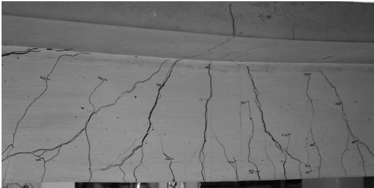
Bild 212 B7.1.2 Biegerisse bei F = 239,4 kN (gespiegelt)
