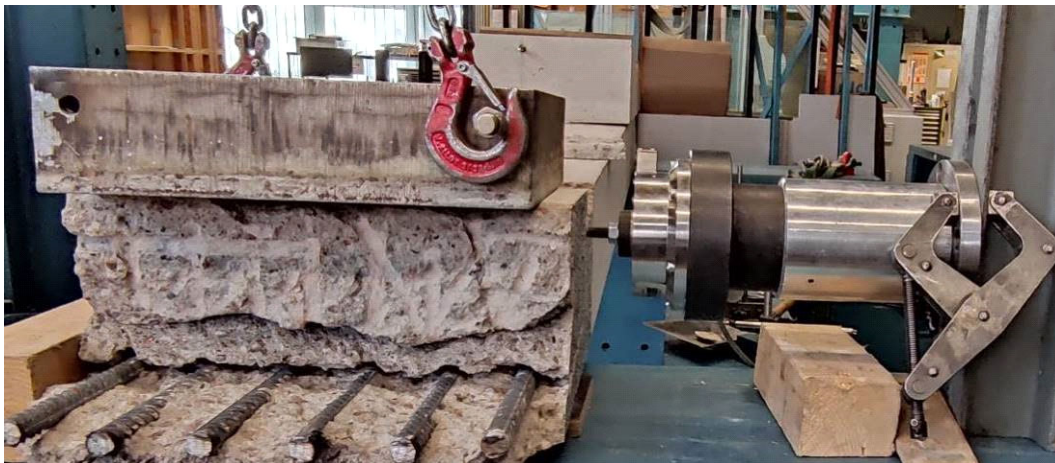
Bild 410 B3.2 Versuchszustand für Schubversuch mit Auflast aus der Seitenansicht
