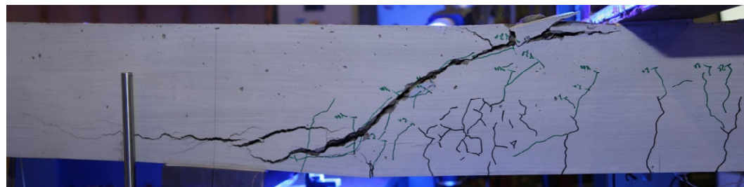
Bild 156 B5.2 Maßgebender Biegeschubriss mit Versagen der Biegedruckzone (gespiegelt)
