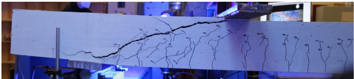
Bild 143 B5.1 Versagensbild: Maßgebender Biegeschubriss, Versagen Druckzone, sekundärer Biegeschubriss (gespiegelt)
