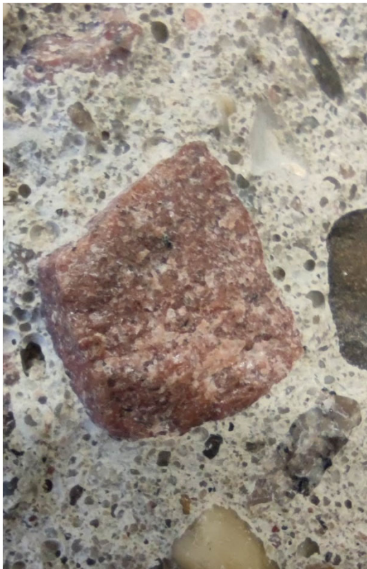
Bild 413 Bereich 3, Einbettung eines Korns
