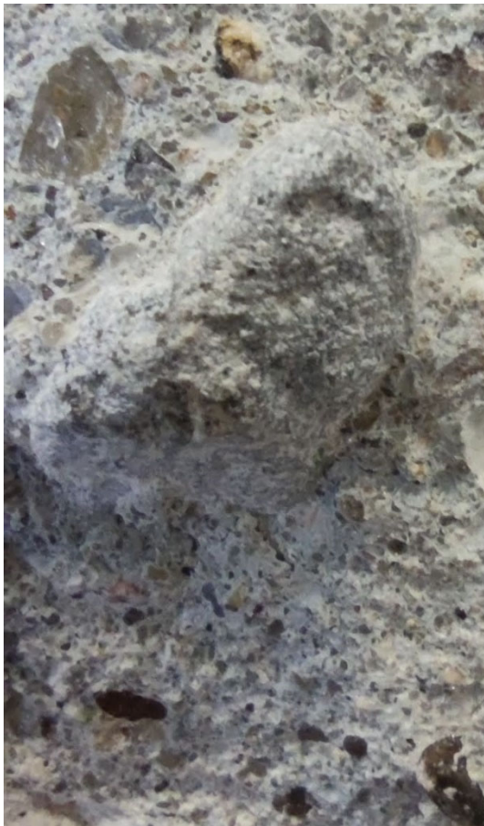
Bild 416 Bereich 1, Einbettung des Korns
