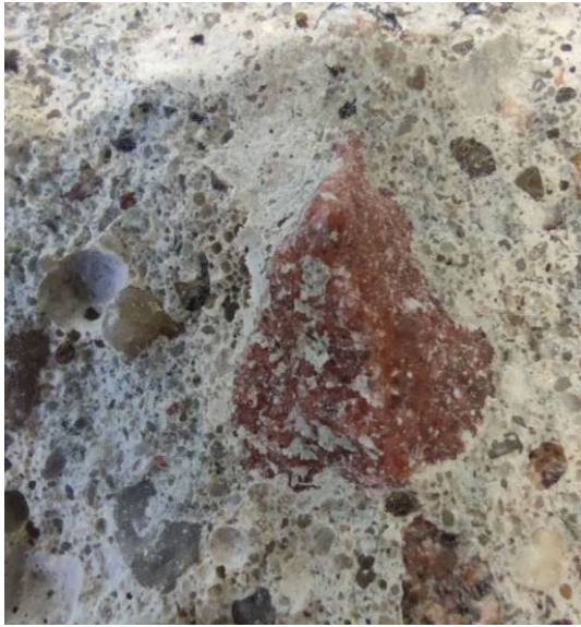
Bild 418 Bereich 2, Einbettung des Korns
