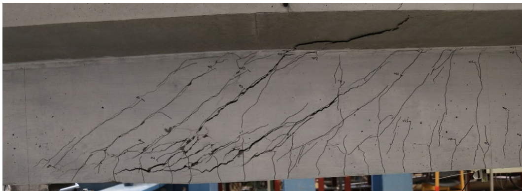
Bild 268 B9.1 Maßgebender Biegeschubriss (gespiegelt)
