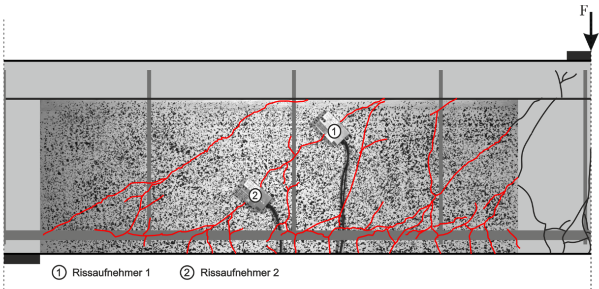
Bild 215 B7.1.2 Photogrammetrisches Messfeld mit Rissbildung anhand Dehnungsfeldes
