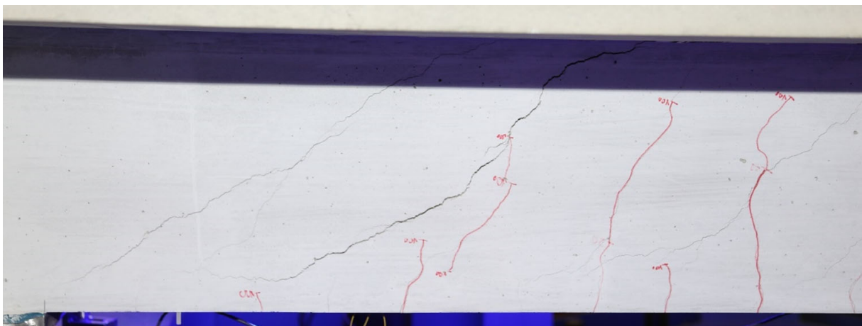
Bild 196 B7.1 Maßgebender Biegeschubriss während des Versuchs (gespiegelt)
