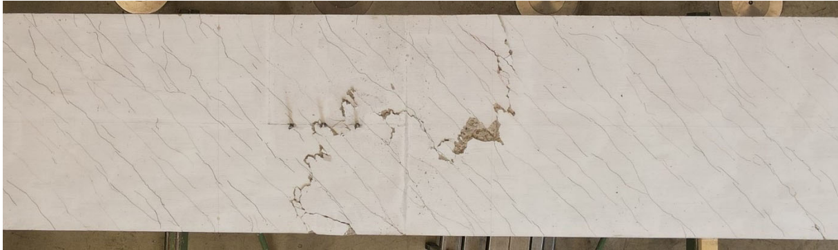
Bild 337 B14 Versagen in Balkenmitte
