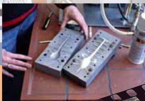
Verena Müller an einer Niederdruck-Spritzguss-Anlage; die Kunststudentin entwickelt ein neues Design für Löffel in Kooperation mit Ingenieurwissenschaftlern der TUHH.
