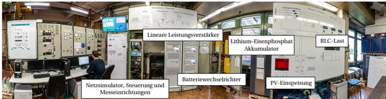
Abbildung 73: Einblick in das Power Hardware-in-the-Loop Simulation Labor (PHiLSLab) der Technischen Universität Hamburg
