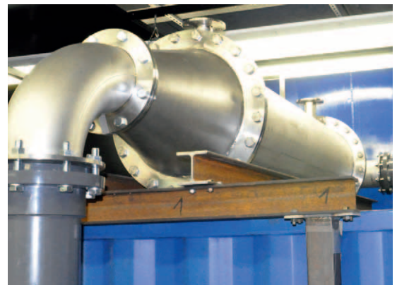
Bis zu 1,3 Millionen Liter Wasser pro Stunde können mit einer Kreiselpumpe (links) umgewälzt und durch einen Wärmeaustauscher (rechts) in den 30 000 Liter fassenden Wassertank (oben) zurückgepumpt werden.
