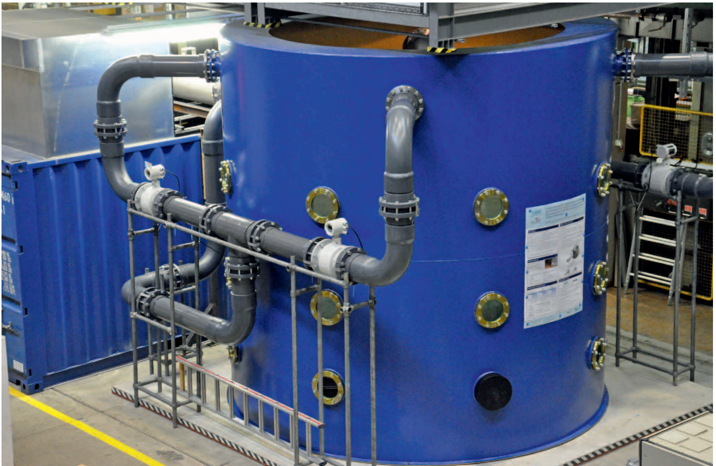
Bis zu 1,3 Millionen Liter Wasser pro Stunde können mit einer Kreiselpumpe (links) umgewälzt und durch einen Wärmeaustauscher (rechts) in den 30 000 Liter fassenden Wassertank (oben) zurückgepumpt werden.
