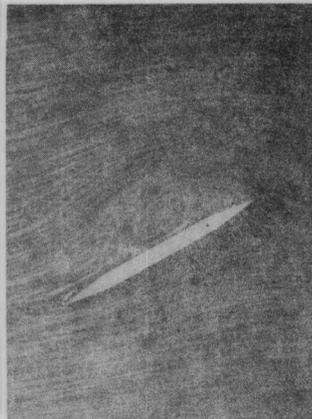
Abb. 18: Zugeschärftes Platten-Ruder, Strömungsaufnahme bei  $\beta = 27,5^\circ$
