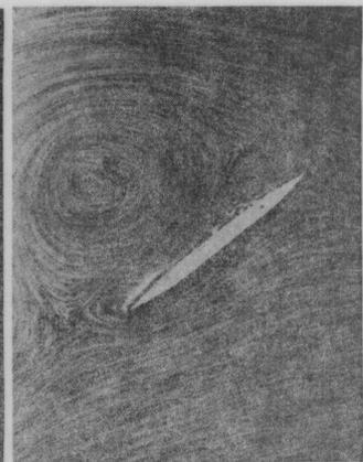
Abb. 20: Zugeschärftes Platten-Ruder, Strömungsaufnahme bei  $\beta = 37^\circ$
