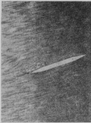
Abb. 17: Zugeschärftes Platten-Ruder, Strömungsaufnahme bei  $\beta = 13^\circ$
