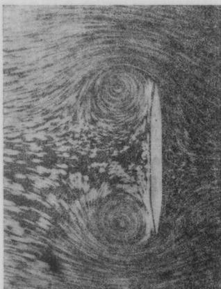
Abb. 25: Zugeschärftes Platten-Ruder, Strömungsaufnahme bei  $\beta = 90^\circ$  (Anfahrzustand)
