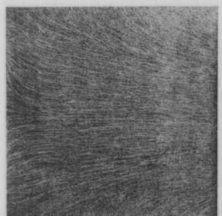
Abb. 28: Zugeschärftes Platten-Ruder 5.11;  $\Lambda = 1,0$ ; Grenzschichtaufnahme bei  $\beta = 25^\circ$ ;  $Re = 0,2 \cdot 10^6$
