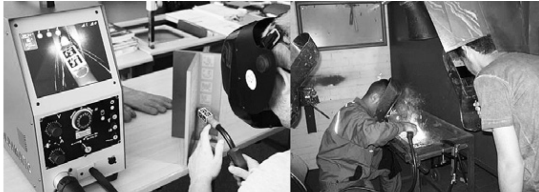
Abbildung 1 Schweißsimulator von Soldamatic im Einsatz mit Auszubildenden (linkes Bild) und MAG-Übung in Schweißwerkstatt der berufsbildenden Schule (rechtes Bild)
