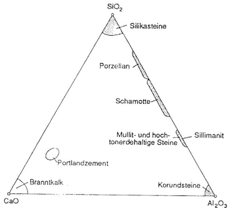
Bild 2. 6-2: Konzentrationsbereiche verschiedener feuerfester Keramiken in einem ternären Konzentrationsdiagramm (nach [21])
