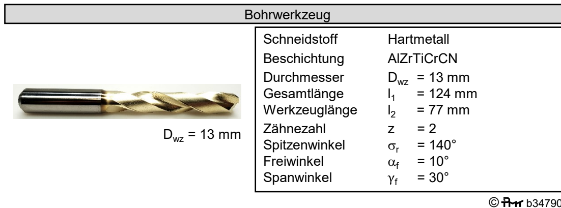
Bild 5.4: Vollhartmetall Bohrwerkzeug
