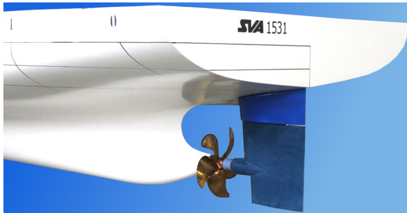
Abbildung 1.2.: Darstellung einer typischen Ruderanordnung im Propellerstrahl am Beispiel eines Containerschiffes im Modellmaßstab (basierend auf [11, S. 47]).
