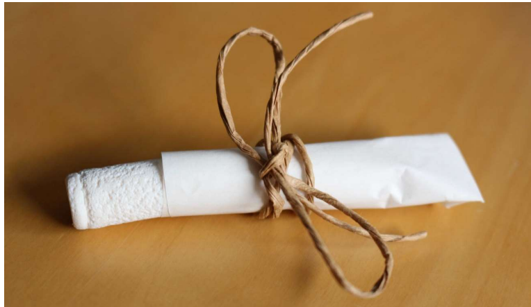
Abb. 6.31: Aerogel-Proteinriegel aus EPI. Gelbildungsbedingungen: 16 Gew.-% Proteinisolatgehalt in 60 Gew.-% EtOH-Lösung, pH 11, T=75 °C, t=45 min. Lösungsmittelaustausch mit EtOH. Überkritische CO 2 -Trocknung: T=313 K, P=12 MPa.
