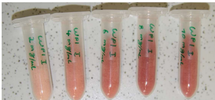
Abb. 6.30: Während des Lösungsmittelaustausches mit Ascorbinsäure beladene WPI I-Aerogelpartikel als Funktion der Ascorbinsäure-Konzentration in Ethanol. Beladungsbedingungen: c=2;4;6;8;10 mg Ascorbinsäure/ml Ethanol, 5 g WPI I-Gelpartikel : 5 ml Ascorbinsäure-Ethanol-Lösung, t=40 h. Überkritische \text{CO}_2 -Trocknung: T=313 K, P=12 MPa.
