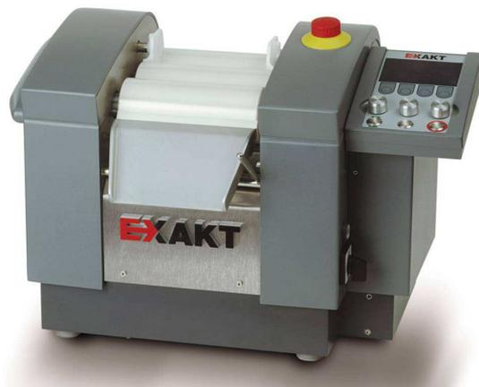
Abbildung 4.2: Foto des zur Herstellung von Celluloseacetat-MWCNT-Nanocomposites verwendeten Dreiwalzwerks 120S der Firma Exakt.
