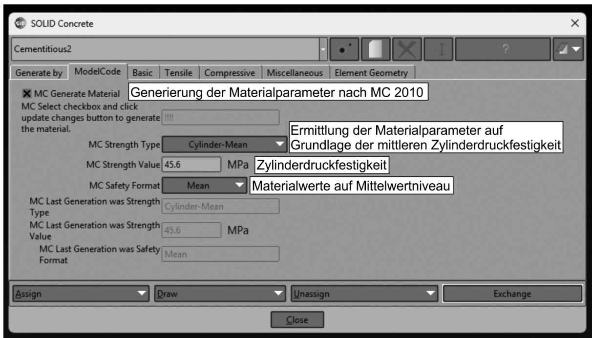
Bild F-2 ATENA Betonmodell „CC3DNonLinCementitious2“: Eingabe für die „Berechnung nach MC10“
