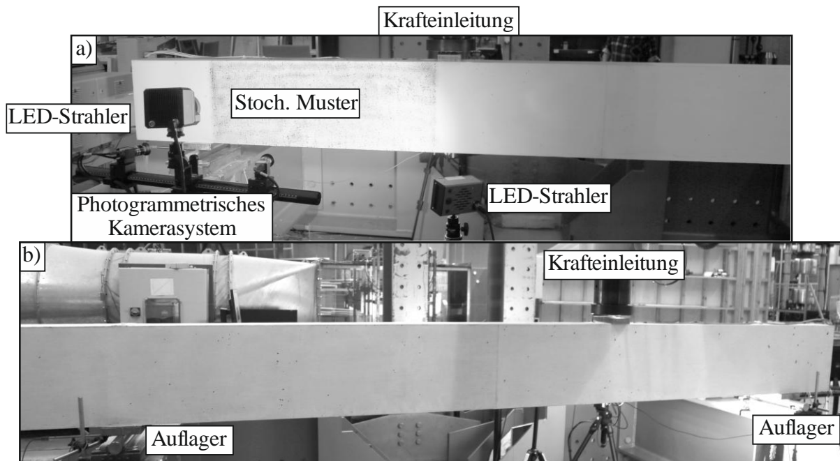
Bild 5-7 Versuchsaufbau am Beispiel des Balkens B2.1: a) Vorderseite mit photogrammetrischem Messsystem; b) Rückseite
