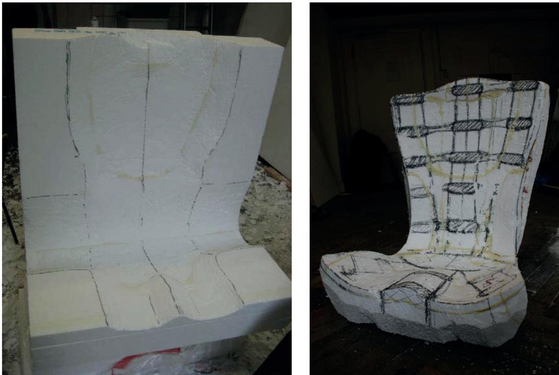
Abbildung 6.14 Herstellung eines Arbeitsmodells aus verklebten Blöcken Polystyrols im Maßstab 1:1
