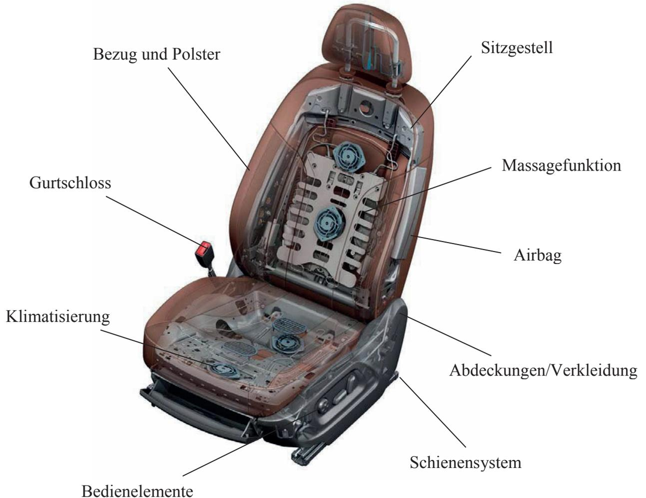
Abbildung 1.2 Beispielhafter Aufbau eines Autositzes<sup>7</sup>
