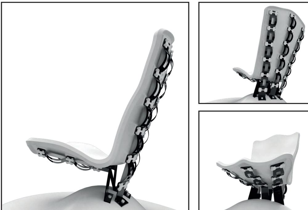
Abbildung 6.21 Technologiedemonstrator einer aktiven Sitzfläche gestützt von Blattfederaktoren
