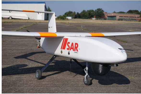
ABB. 4.3: Starrflügel UAV mit herkömmlichem Fahrwerk auf einer befestigten Landebahn ( Hanseativ Aviation Solutions, 2022 )
