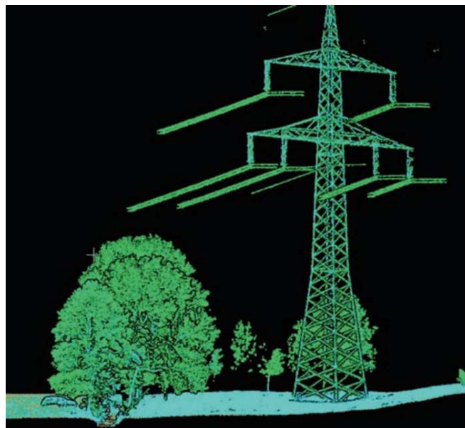
ABB. 3.8: LIDAR Vermessung der Mastgeometrie sowie der angrenzenden Stromleitungen ( Schultze, 2020, S.717 )
