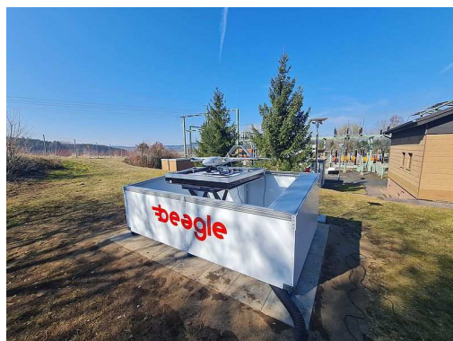
ABB. 4.6: Automatisierte Betriebsbasis für eine VTOL Drohne der Firma Beagle ( Hamburg Aviation Cluster, 2022 )
