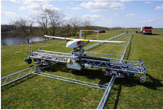
ABB. 4.4: ElektRail Start- / Landesystem (Prototyp) mit UAV
