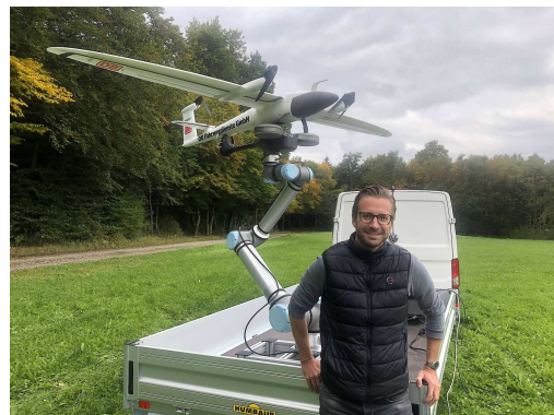
ABB. 4.7: VTOL Drohne des Anbieters Quantum Systems im Testbetrieb bei der Deutschen Bahn ( Köhn, 2020 )
