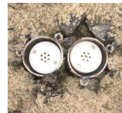
In das Deckwerk werden Sonden installiert. Sie messen die Kräfte, die Wellen auf den Stein-Klebstoff-Verbund ausüben.
