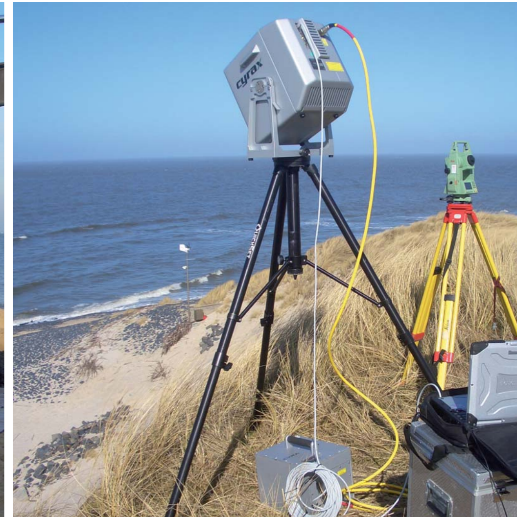
Mit Hilfe eines Laserscanners (unten) untersuchen die Wissenschaftler, ob die Deckschicht abgesackt oder erodiert ist. Auf dem so erzeugten Bild (links) werden die unterschiedlichen Höhen farblich markiert.
