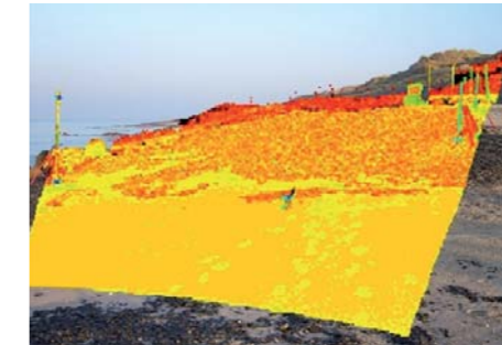
Mit Hilfe eines Laserscanners (unten) untersuchen die Wissenschaftler, ob die Deckschicht abgesackt oder erodiert ist. Auf dem so erzeugten Bild (links) werden die unterschiedlichen Höhen farblich markiert.
