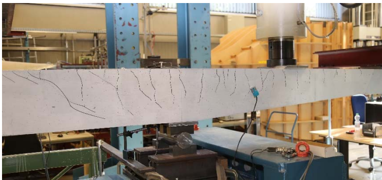
Bild 31 Balken T3 - Rissbild bei einer aufbrachten Last von 75 % von F_2
