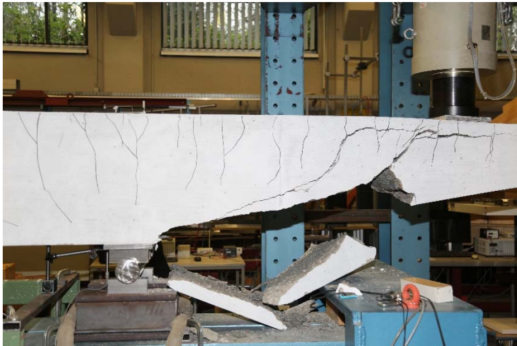
Bild 44 Balken T6 nach Abschluss des Versuches
