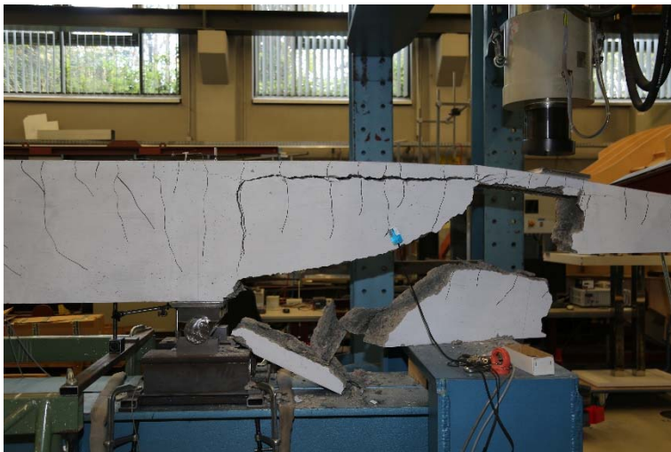
Bild 40 Balken T5 nach Abschluss des Versuches
