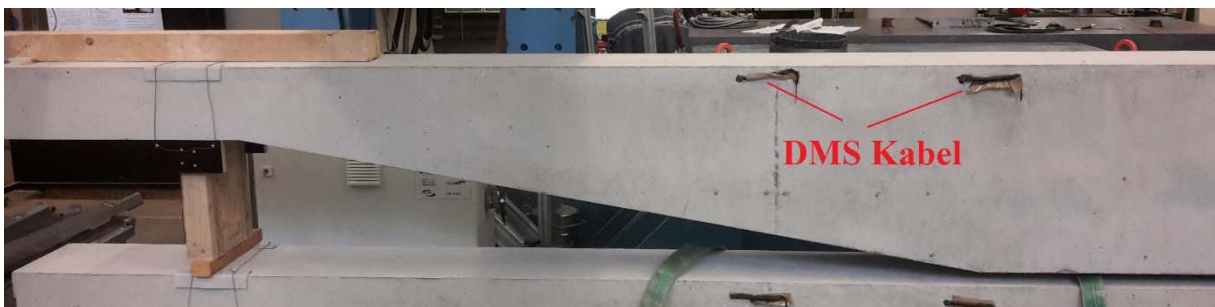
Bild 2 Balken T5 kurz nach dem Ausschalen
