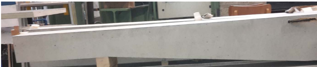
Bild 1 Balken T3 kurz nach dem Ausschalen
