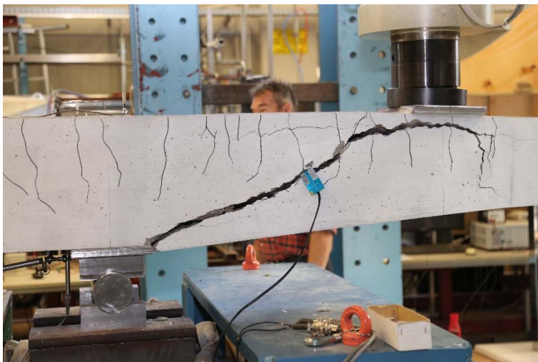
Bild 32 Balken T 3 nach Abschluss des Versuches
