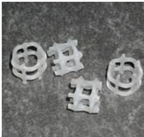
Abb. 15: Füllkörper des Technikumsbiowäschers (HiFlow Pallringe, 15 mm)
