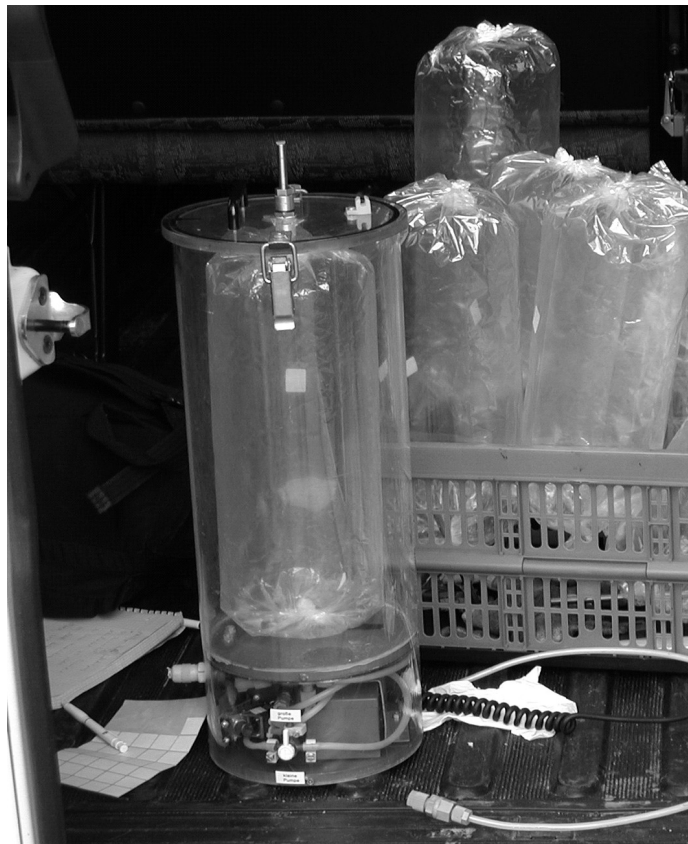
Abb. 9: Skizze und Foto eines Probennehmers für die Entnahme von Geruchsproben nach dem Lungenprinzip
