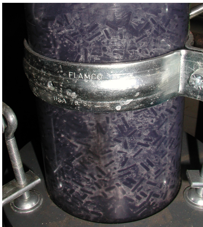
Abb. 77: Foto der mit Mikroorganismen bewachsenen Aktivkohle
