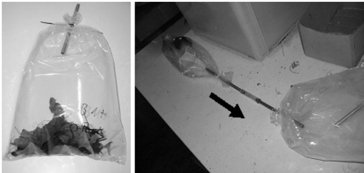
Abb. 12: Statisches Testsystem (links), Überführung der behandelten Abluft in einen neuen Beutel (Abbruch der Reinigungsphase, rechts)
