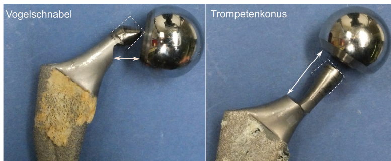
Abbildung 18: Explantierte Schaftkone verschlissen als „Vogelschnäbel“ (links; n = 8) oder in einer „Trompetenform“ (rechts, gebrochener Konus; Abbildung 7; n = 1). Weiße Pfeile markieren die zusätzlich entstandenen Kontaktflächen zwischen der Unterseite des Kopfes und dem Prothesenhals. Der Schaftkonus in seiner ursprünglichen Form wurde eingestrichelt (gestrichelt).
