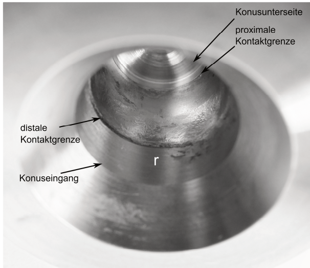
Abbildung 17: Blick von kaudal in den Kopfkonus eines Explantats (Pat. 10; Tabelle A 1). Matt oder blank erscheinende Verschleißtexturen setzten sich klar vom Bereich des Konus ohne Kontakt am Konusmund ab, auf dem lediglich vereinzelt dunkler Auftrag zu erkennen war (r). Ein Referenzband distal des Kontaktbereichs fand sich auf allen Explantaten. Konusbereiche des Kopfkonus ohne Kontakt im Konusschlund waren aufgrund einer Hinterschneidung oft nicht verfügbar (Konustyp 2b; n = 29).
