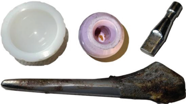
Abbildung 8: Komponenten des bi-modularen Prothesenmodells Rejuvenate im Zustand der Übermittlung an das Institut für Biomechanik (Schaft, Halsadapter, Kopf, Pfanne; Patient 2; Tabelle A 2). Am Schaft sind Reste des eingewachsenen Knochens zu erkennen. Konusoberflächen runder und flacher Kone waren verschmutzt.
