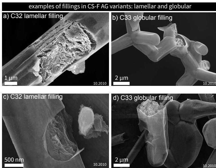
Abb. 6.20: SEM-Aufnahmen für CS-F-AGs mit sehr massereichen inneren graphitischen Füllungen. Treten bei hohen Raten der Kohlenstoffzufuhr solide Füllungen auf, kann eine lamellare (vgl. a,c)) Struktur oder eine globulare (vgl. b,c)) ausgebildet werden. Bisher ist keine Möglichkeit der äußeren Beeinflussung identifiziert. Bisher scheinen in CS-F-AGs globulare Füllung zu dominieren (ca. 85-95% der Fälle).
