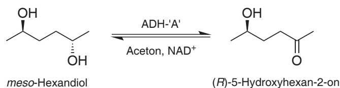
Abbildung 4.14: Schema der stereoselektiven Oxidation von meso -2,5-Hexandiol.
