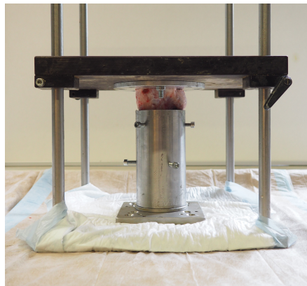
Abbildung 3.8: Mithilfe des Vierbeintisches im Einbetttopf fixierter Knochen.
