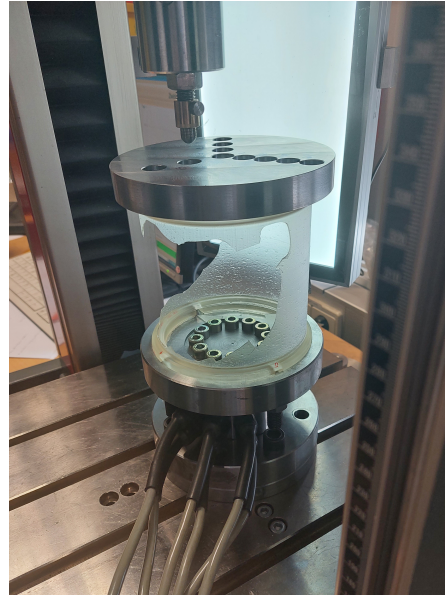
Abbildung 4: Versuchsaufbau mit einem bereits getesteten und zerstörten Zylinder
