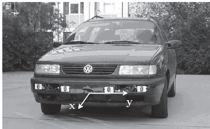
Abbildung 4.10: Testfahrzeug mit einem Sensornetzwerk aus vier Pulssensoren zur Positionsbestimmung über Trilateration
