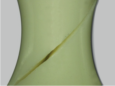
Aluminiumoxid - Keramikbruch unter reiner Torsion - Siliziumcarbid
