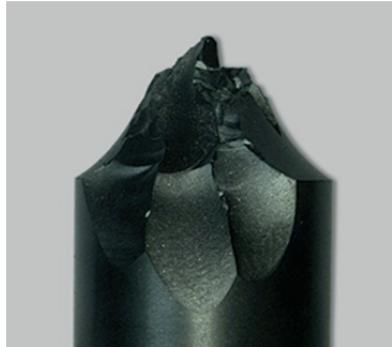
Bild 54: Bruchflächen bei überlagertem axialem Druck
