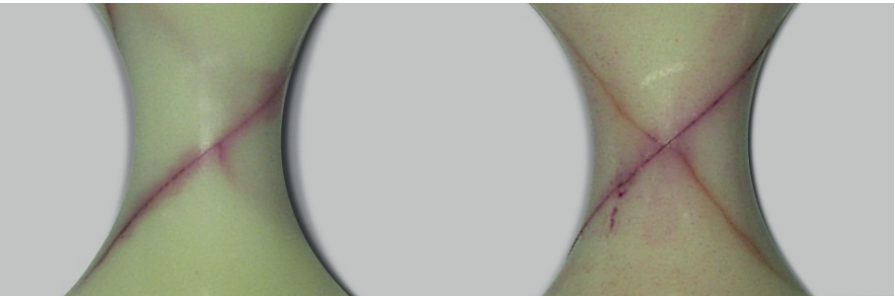
Bild 55: Anriss einer Aluminiumoxidprobe nach zyklischer Torsion mit überlagertem Druck (links schwellend, rechts wechselnde Beanspruchung)
