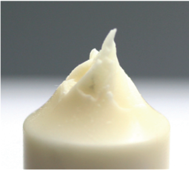
Bild 54: Bruchflächen bei überlagertem axialem Druck
