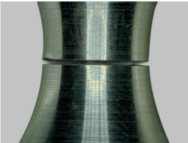
Aluminium - metallischer Bruch unter reiner Torsion - Aluminium
