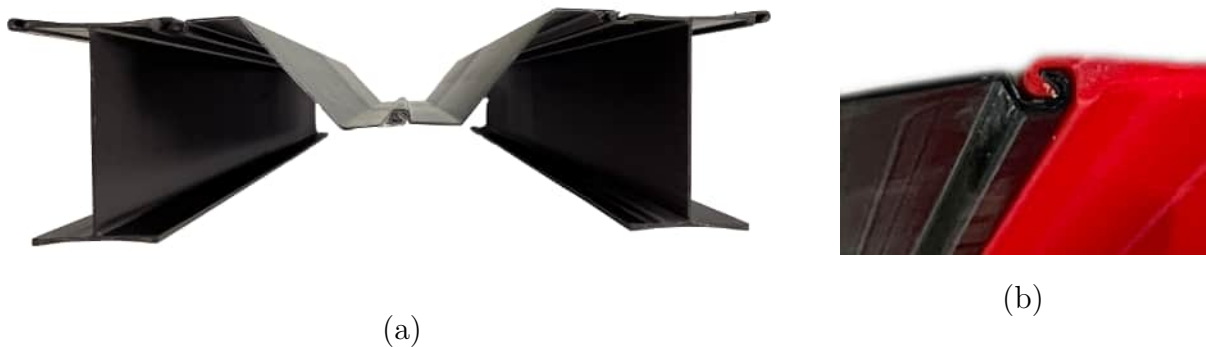
Abb. 4.1: Kombinierte Spundwand, welche im Maßstab 1 : 10 im 3D-Druck mit dem Verfahren der Schmelzschichtung hergestellt wurde (a) und Detail der Schlossverbindung (b)
