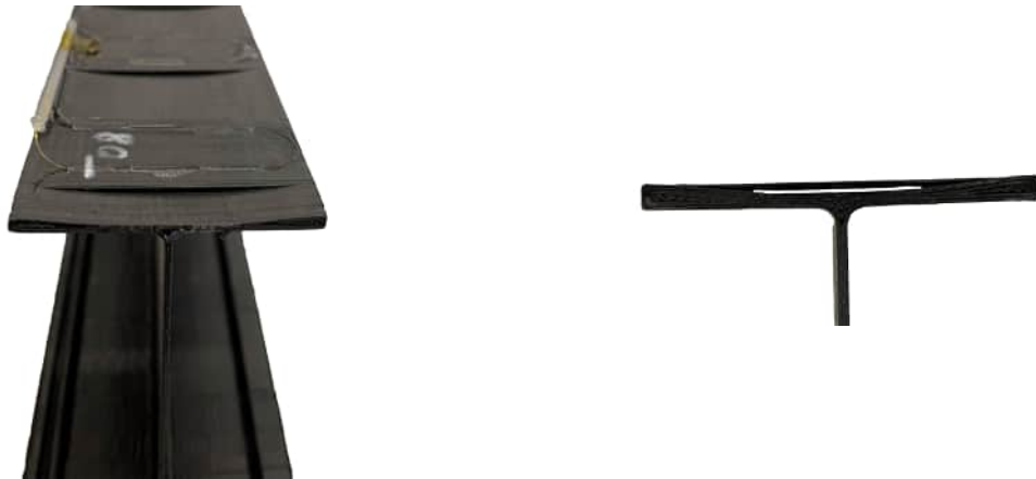
Abb. 6.9: 3D-gedruckter Träger mit den integrierten Drucksensoren als verformbare „Plättchen“ auf dem aktiven Flansch
