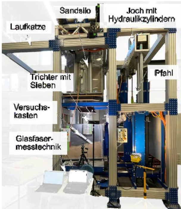
Abb. 6.5: Versuchsstand zur Pfahleinbringung
