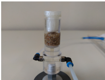
(a) Sandprobe ( h/d = 12\text{mm}/12\text{mm} )
