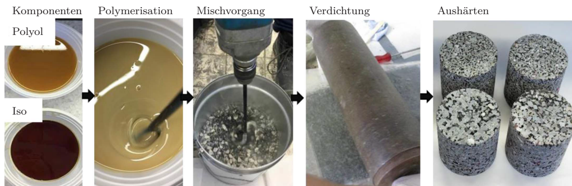
Abbildung 4.6: Herstellungsprozess von PUPM, nach G. Lu, Törzs u. a. (2020).
