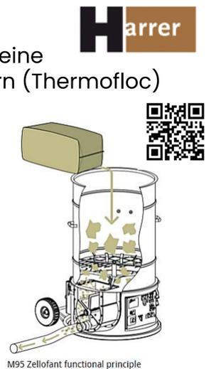
Fig.2 Einblasdämmung von Gemischen aus Lignin-Aerogel und Zellulosefasern.
