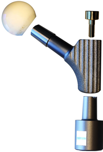
Abb. 1 ▲ Verwendete Komponenten, dargestellt als Explosionsbild. Der distale Schaft wurde durch den Hersteller für die Verwendung in einer Materialprüfmaschine angepasst
