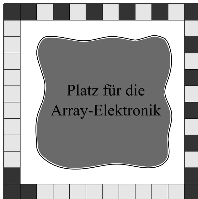
Abbildung 5.8: Ein Beispiel für einen platzsparenden Radaraufbau mit einem Rahmen-Array.
