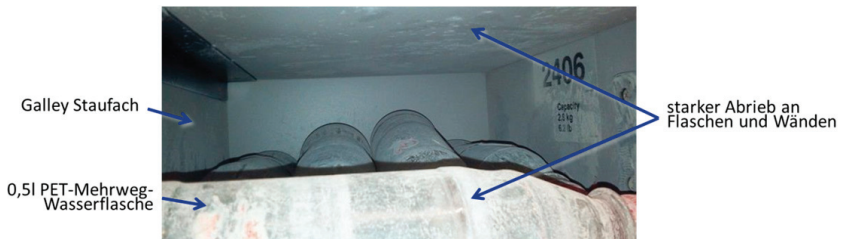
Bild 23: Abrieb an Füllmassen für das Kabineninterieur in dynamischen Versuchen
