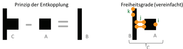
Bild 36: Prinzip der Entkopplung in der dynamischen Substrukturierung
