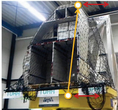
Bild 53: Übersicht des Versuchsaufbaus der Galley in der Beladungsvariation GA1.2 fixed only mit Verstärkungsfunktion zwischen Anregung der Basisplatte und der rechten oberen Ecke in Y-Richtung
