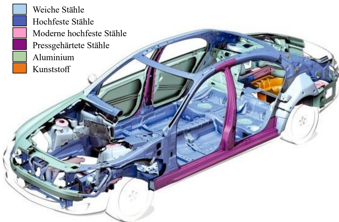
Abbildung 19: Verschiedene Werkstoffe der Karosserie einer Mercedes-Benz S-Klasse (BR 221) [46].
