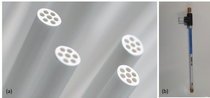
Abbildung 22: Foto der Multibore Membranen der Firma Inge/Dupont (a) [57], Foto der verwendeten Labormodule der Multibore Membranen (b).
